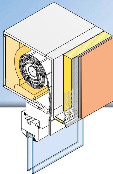
Das **APU-Aufklebeprofil DUE** wird in Wärmedämm-Verbundsystemen horizontal z. B. bei Putzan-schlüssen auf Rollladenkästen eingesetzt. Die gekröpfte Profilkontur bietet eine sichere Lösung hinsichtlich der Wasserführung nach unten.
